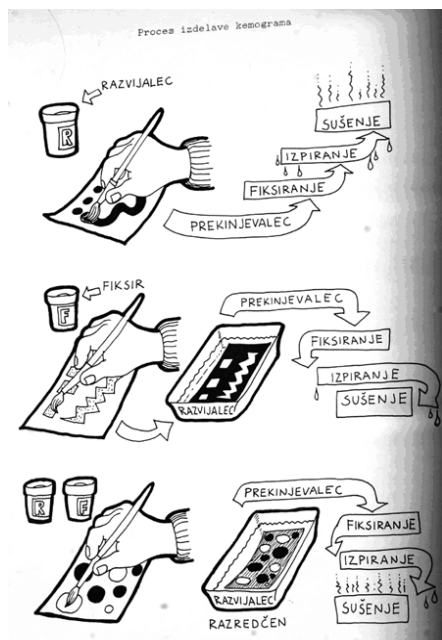
Slika 5: Prikaz izdelave kemograma
